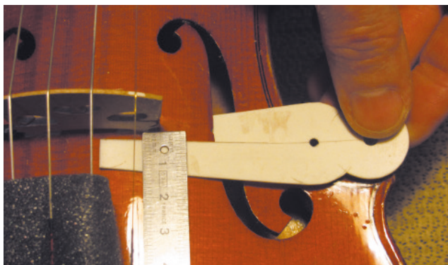
Fig. 3. Mesure de la position de l'âme au moyen d'un feuillet fendu et d'un réglet
